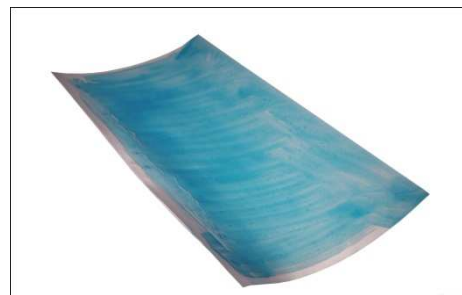
Bild 2 durchgetrocknete Matrix MP Magic Blue auf Alufolie, bereit zur direkten Verklebung
