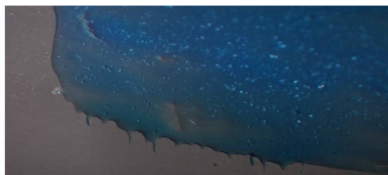
Bild 3 Getrocknete Matrix Magic Blue auf 0.30 mm Alufolie, stark selbstklebend
